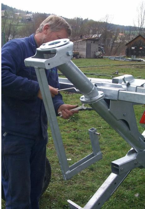
La pieza de unión del aspersor con el péndulo, girarla en 90° hacia la posición de trabajo, poner las juntas y montarla de nuevo.
