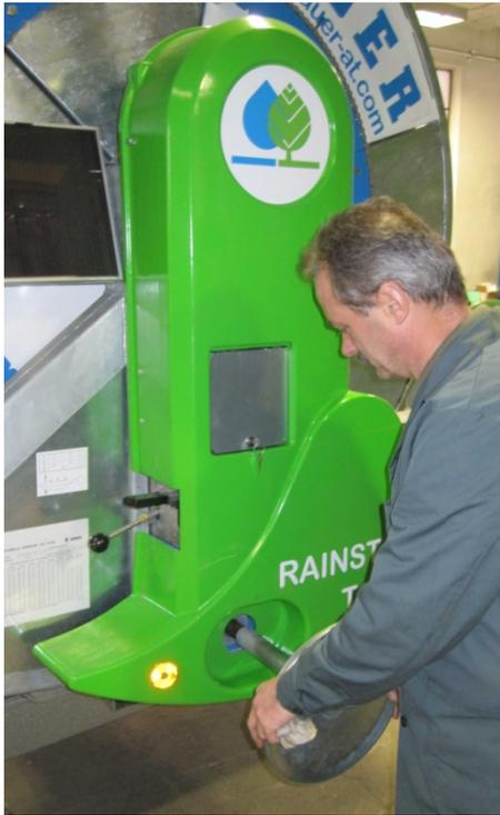
8. Doble la protección de mando hacia arriba y cierre con la barra. Ponga el volante en el eje con la ranura (superior de la toma de fuerza) y desenrollar el tubo PE casi 40cm a través de girar el volante.
